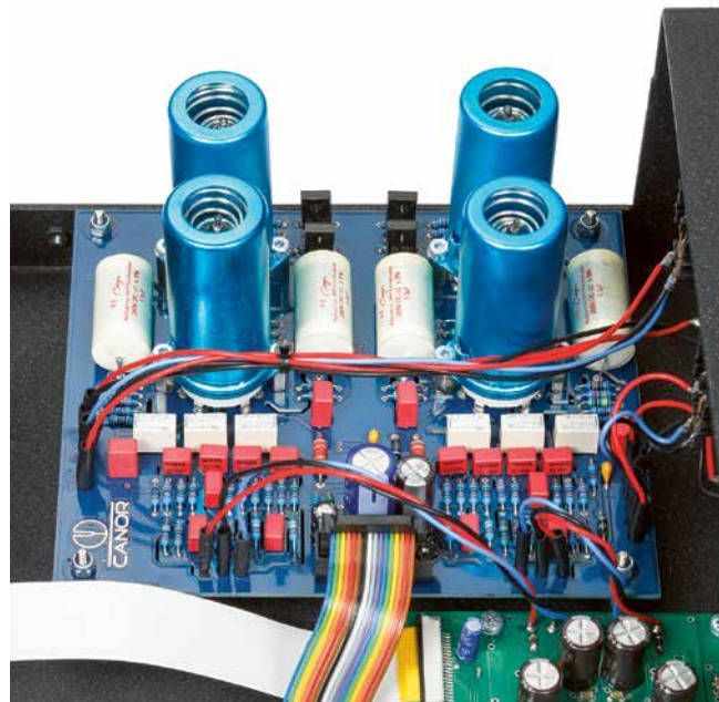
Gleich vier 6922-Röhren bilden die symmetrische Ausgangsstufe des slowakischen Ausnahmeplayers.
