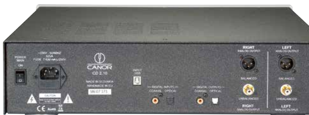
Der DAC nimmt Digitalsignale via USB sowie koaxial/optisch entgegen.
